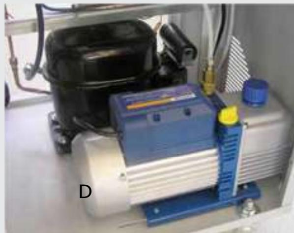
При отображении сообщение "Заменить масло в вакуумном насосе", нажмите ESC и ОК, "Вакуум часы" в меню Сервис. После замены масла нажмите кнопку ОК, чтобы сбросить счетчик.
